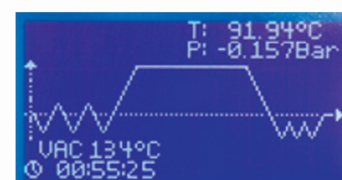
شکل ۱۴ سه مرحله وکیوم انتهایی و ورود هوای فیلتر شده
